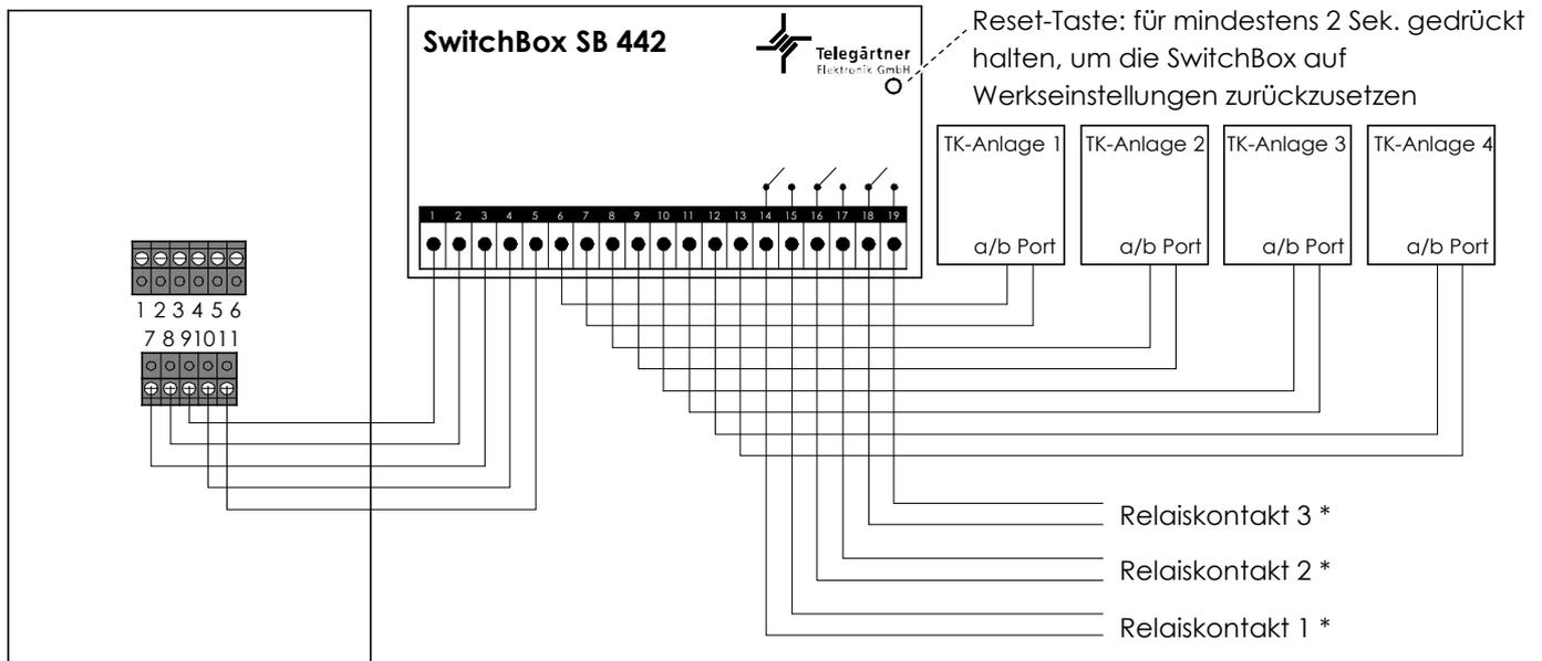
Reset-Taste: für mindestens 2 Sek. gedrückt halten, um die SwitchBox auf Werkseinstellungen zurückzusetzen
